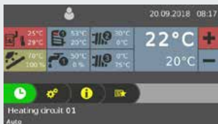
Fig. 1 General oversigt over varmekredse (start skærm)
