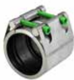
Serie 745/20 Repico® "Slip"-kobling Universal og ikke-trækfast til alle rørtyper NBR- eller EPDM-pakning DN15-600 Rustfrit stål AISI 316
