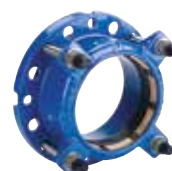
Serie 623/10 Supa Plus™ flangeadapter Trækfast til PE- og uPVC-rør Universal flangeboring DN40-300 PN10/16 Duktiljern
