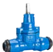
Serie 03/30 Stikledningsventil med trækfaste mufteender til PE-rør DN20-50 PN16 Duktiljern
