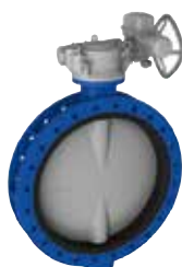
Serie 820/20 Butterflyventil Centrisk med løs gummiliner U-sektion DN150-1600 PN10/16 Duktiljern
