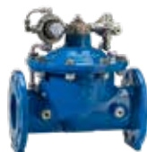
Serie 859 Reguleringsventil Trykreducerende DN50-600 PN10/16 Duktiljern/AISI 316
