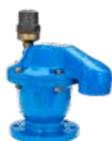
Serie 701/50 Kombinationsudluftnings- ventil Indløbsflange DN50-300 PN16 Grå støbejern/ forstærket polyamid
