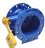
Serie 874 Tiltet disk kontraventil med arm og vægt DN150-1600 PN10/16 Duktiljern
