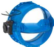
Serie 756/106 Butterflyventil Dobbelt-excentrisk Dobbeltflange Integreret sæde IP 68 gearboks DN150-2800 PN10/16 Duktiljern
