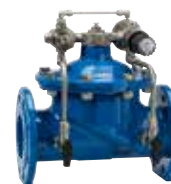
Serie 859 Reguleringsventil Trykholde DN50-600 PN10/16 Duktiljern/AISI 316
