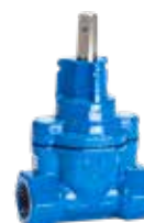
Serie 03/00 Stikledningsventil med indvendigt BSP gevind DN25-50 PN16 Duktiljern
