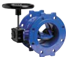
Serie 756/100 Butterflyventil Dobbelt-excentrisk Dobbeltflange Integreret sæde IP 67 gearboks DN200-2800 PN10/16 Duktiljern
