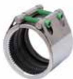
Serie 745/01 Repico® "Grip"-kobling Universal og trækfast til alle metalrør NBR- eller EPDM-pakning DN15-400 Rustfrit stål AISI 316
