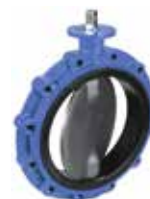
Serie 75/41 Butterflyventil Centrisk med fast gummiliner Full lug DN50-1200 PN10/16 Duktiljern
