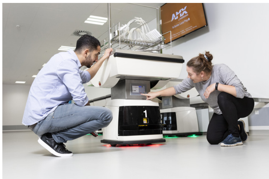
Mujtaba Abdulridha (t.v.) og Anita Madsen ved en AGV (Automated Ground Vehicle), som anvendes til at transportere vaskestativer mellem arbejdsstationer og vaskemaskiner. Der anvendes AGV'er på både den rene og urene side. AGV'erne er ret selvkørende og giver lyd samt skifter farve, hvis man står foran den.
