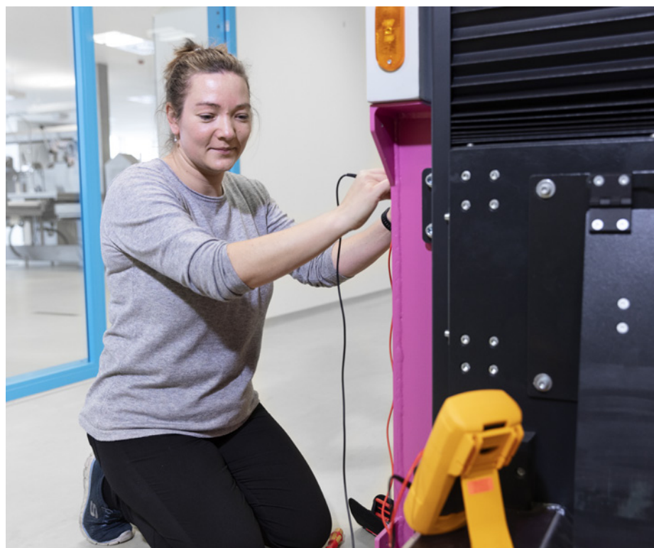
Anita Madsen måler batteriniveauet på en stor AGV, som transporterer stativer fra en fyldestation til kabinetmaskinen.
