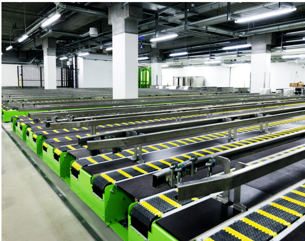
Banerne, der ses her, deler sig afhængig af, hvilken hospitalsafdeling de skal leveres til, hvor de vil blive hentet af en stor AGV på den anden side. De to nye sterilcentraler skal levere steriliserede hospitalsinstrumenter til hospitalerne i Region Hovedstaden.
