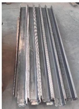
Billede 5: 288 stk. vinkelprofiler 90x90x5 mm, længde 2.000 mm til montering af loft.
