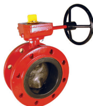
Serie 75/20 Centrisk dobbelt flange butterflyventil NBR liner Duplex disk DN 50-300 PN 10/16 Duktijern VdS godkendt FM godkendt
