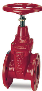
Serie 06/35 Flangeventil med positionsindikator og håndhjul Byggelængde DIN F4 DN 50-400 PN 10/16 Duktijern VdS godkendt
