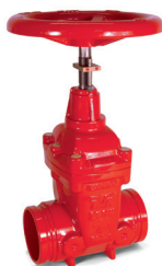
Serie 06/37 "Grooved ends" afspærringsventil med positionsindikator og håndhjul DN 50-300 PN 16 Duktijern VdS godkendt
