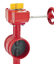
Serie 815 Centrisk butterflyventil med gummi-vulkaniseret disk "Grooved ends" iht. AWWA C606 DN 65-200 300 PSI Duktijern UL/ULC listet, FM godkendt
