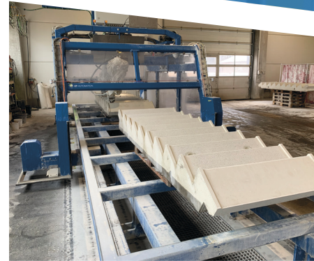
Sliberobot til beton trapper
