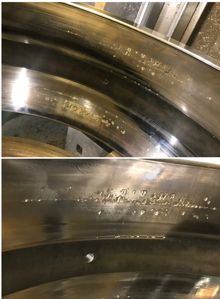
Bild 10 Skalning på ytterringen på lagret som byttes i oktober 2020.
