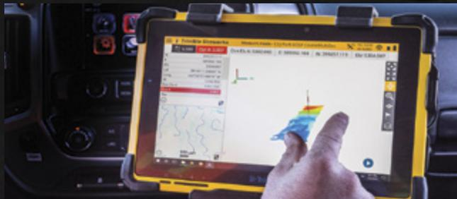
**Trimble Siteworks positioneringsystem til tilsynsførende** består af SPS986 eller SPS785 GNSS smartantenne, Trimble T7 eller T10 tablet og Siteworks-software. Tilsynsførende ude i marken kan nu arbejde med komplette kontorsoftwarepakker inkl. data og 3D-modeller uden at skulle medbringe en bærbar computer.
