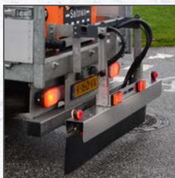
Bom i rustfri stål og sidedyser
