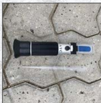
Refractometer og pipette til kontrol af blandingsforhold
