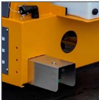
Bom i rustfrit stål
