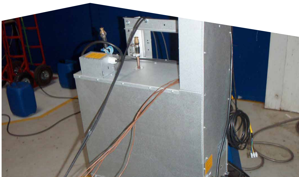
På Teknologisk Institut i Aarhus måles på komponent-optimeringen af prototypen på NILAN's nye lavenergivarmpumpe.
