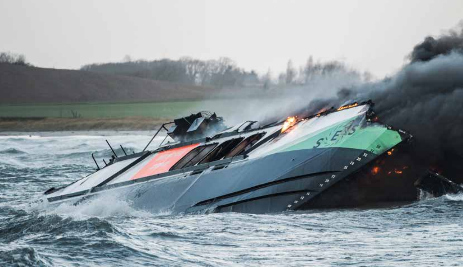
Kun 15 min. efter, branden var visuelt bekræftet, var hele FRP-skibet Umoe Ventus omspændt af flammer. Foto: Andreas Bastiansen.
