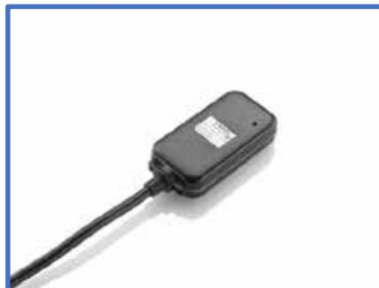
Derudover udsendes det lovligt krævede andet bevægelsessignal til den digitale fartskriver. For køretøjer, hvor det krævede signal ikke er tilgængeligt via køretøjets elektriske udstyr, kan dette let videreføres med DTCO® GeoLoc via GPS-teknologi.
