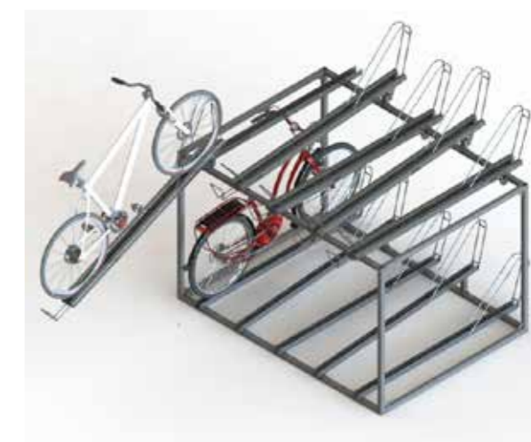
2 etager, monteret med skinner til udtræk.
