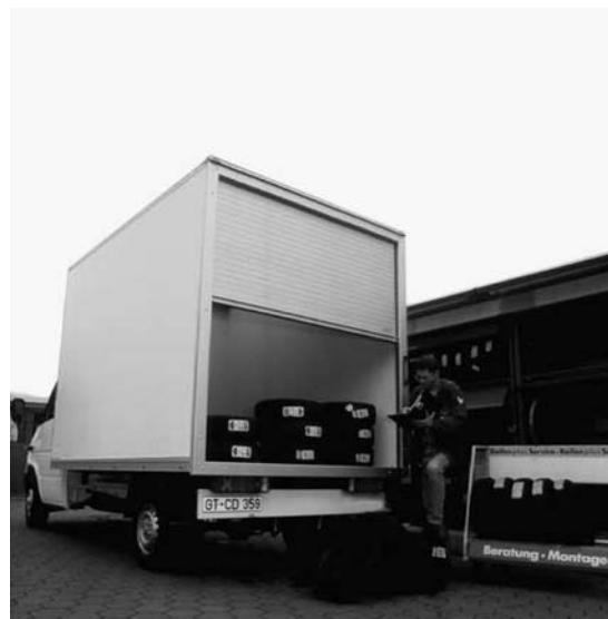
Fjederrullen hjælper med at åbne jalousiet
