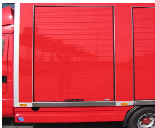
ROLL-TO 50 monteret med dobbeltgrebslås
