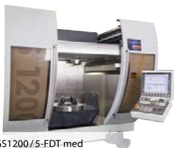
GS1200/5-FDT med rundbord-Ø 800 mm.
