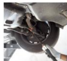
Opvarmning af styretøjsdele
