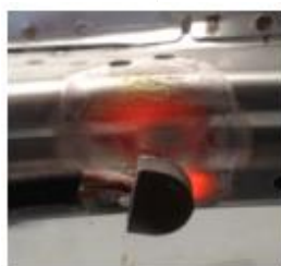
Opvarmning af vanger (ikke HHS)
