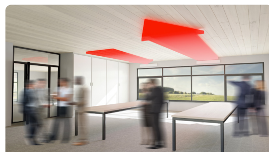
MicroVent Comfort Control sætter alle ventilationsenheder til energibesparende grundventilation, når behovet for ventilation er lavt, og skruer automatisk op, når behovet stiger.
