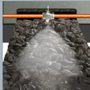
En indvendig rund dyse med bred vinkel bruges til at holde støv nede under produktionen af kulbriketter.
