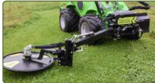
Kant-/Stolpklippare RI monterad.
