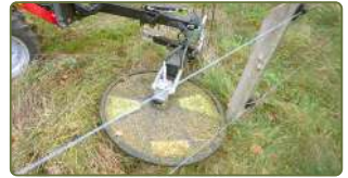
Kant-/Stolpklippare RI monterad.
