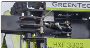
AHS hydraulisk påkörningsssäkring med redskapsretur, detta optimerar arbetet och säkrar maskinen från överbelastning (standardutrustning).
