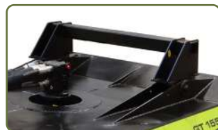
Hållaren för redskapsfästet har rörlighet så kedjehuvudet följer underlaget.
