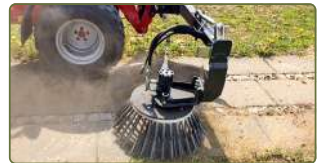
Ogräsbörste BR för mekanisk ogräsbekämpning på hårdgjorda ytor.
