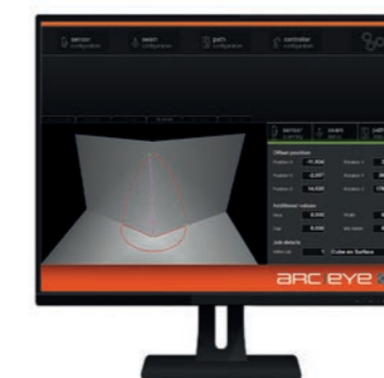
3D Seam-Finding: Hörnet söks och hittas i en sökning.
