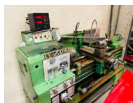
CY drejbænk CY-L1640-G Drejælængde 1000 mm, 2-akset Heidenhain digitaludstyr
