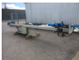
Rasi CNC rørbukker Type S80 2L V3, årg. 2001 Max. Ø80 mm, 6 m lang
