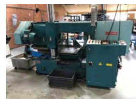
Bigstone båndsav Kapacitet 420 mmØ, 5,5 kW, 500mm fremføring, velholdt
