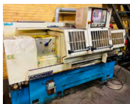
Microweily drejbænk sving o. vange 460 mm, sving o. tværsl. 230 mm, årg. 1999
