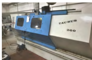
Pinacho CNC drejbænk Taurus 260, Fagor 8055 CNC drejlgd. 1500 mm, årg. 2000
