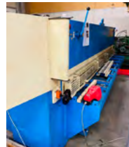
Haco maskinsaks Type TS3006, årg. 2000, 3050 x 6 mm, mot. bagstop
