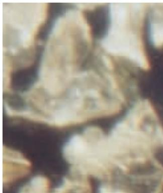
*Aluminiumoxyd – AO – sehr hohe Mikrohärtigkeit mit 21000 N/mm<sup>2</sup>, weniger scharf ausgeprägte Kanten*
