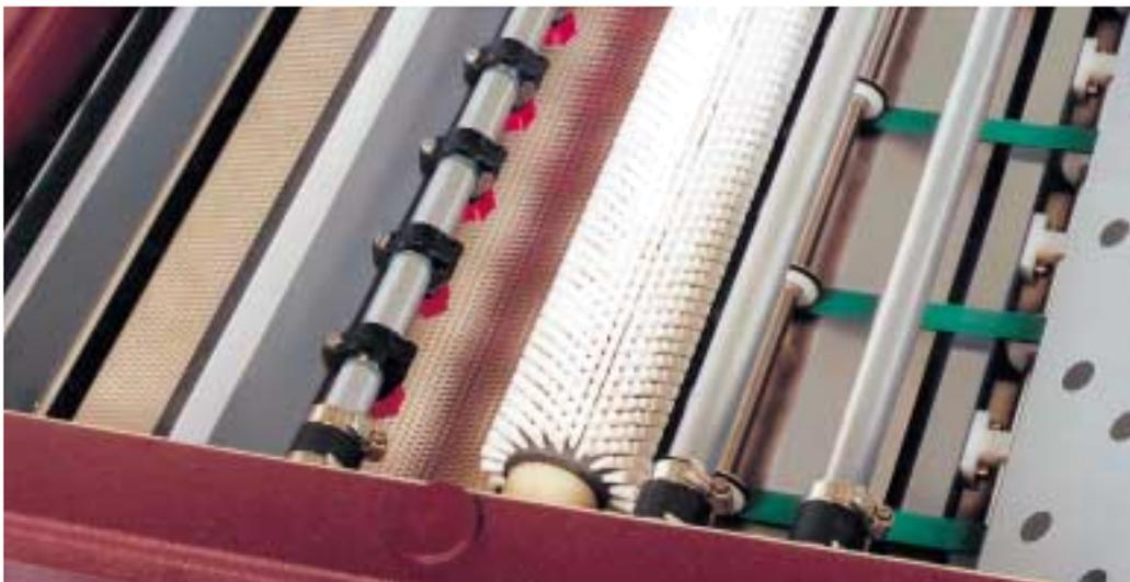
*Walzenbürsten sind in Offsetdruckplatten-Entwicklungsmaschinen unentbehrlich.*
