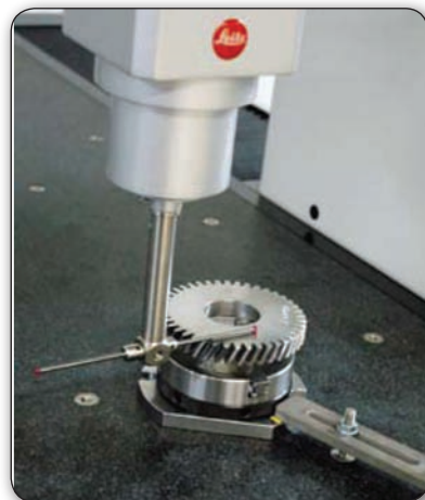
BIMAQ anvender Leitz Reference koordinatmålemaskine til 3D måling af tandhjul. Maskinen er udstyret med LSP-S2 målehoved til opsamling af data fra hver enkelt tand, tandhjulfront og tandhjulshul.
