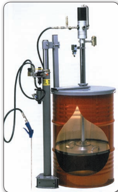
Konceptet "total tømning". Kun maks. 1,9 kg fedt tilbage i en 200 kg tromle
