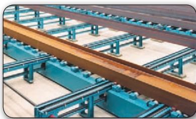
Transportsystem med skinner og trækkæder
