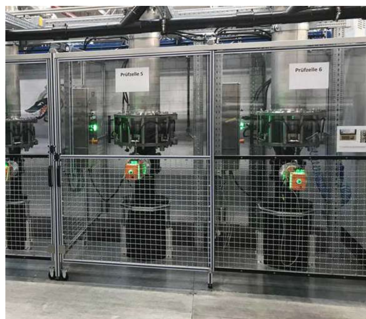
For at sikre den høje kvalitetsstandard er butterflyventilerne testet under de hårdeste forhold i en test-opstilling.
