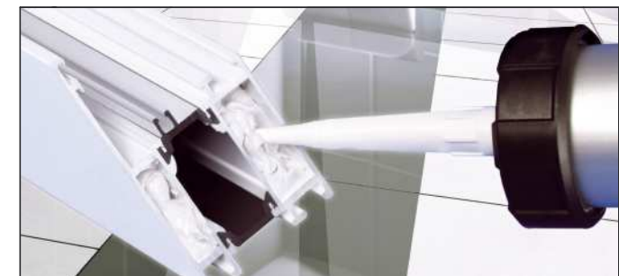
Limpåføring i profil kammeret (1-komponent lim)
