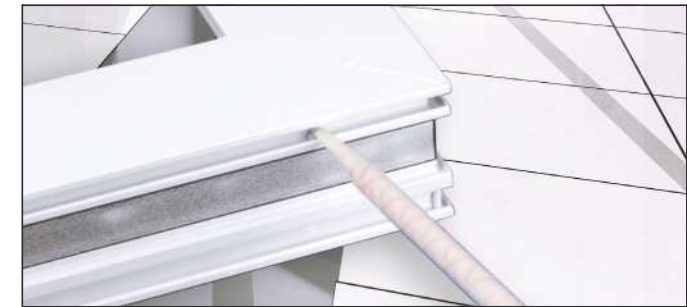
Injektion af klæbemidlet ind i profil kammeret (2-komponent lim)
