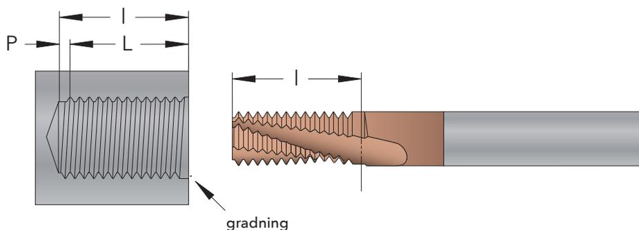
För att få en fin ingång och en gradfri gänga måste du förflytta verktyget skärkantlängden (l) in i hålet innan du börjar gängoperationen. Gänglängden (L) blir skärkantlängden (l) minus en stigning (P).
