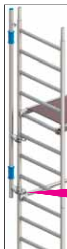
Fig. 4: Tilslutning af opskydeligt rækværk til stilladsgavlen
