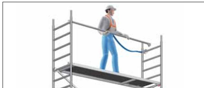
Fig. 3: Sikker montage af rækværket ved brug af faldsikringsudstyr
