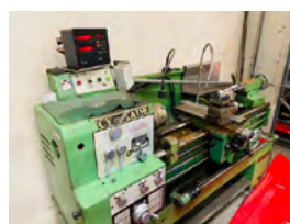
CY drejebænk CY-L1640-G Drejælængde 1000 mm, 2-akset Heidenhain digitaludstyr
