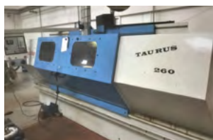
Pinacho CNC drejebænk Taurus 260, Fagor 8055 CNC drejeldg. 1500 mm, årg. 2000
