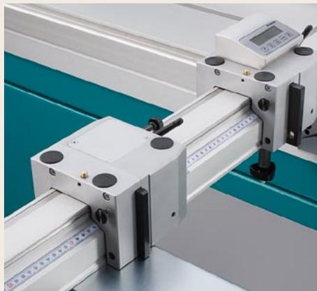
Zusätzliches Anschlagelement T7539 am Längenanschlag T7540
