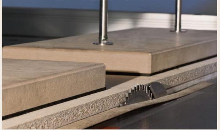
Mehr Flexibilität durch Drucksegmente
