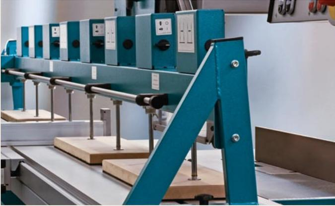
T7570/5-b Pneumatischer Druckbalken
