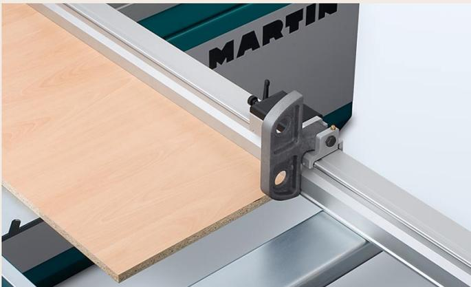
Analoger Längenanschlag mit durchgehender Anlage T7537
