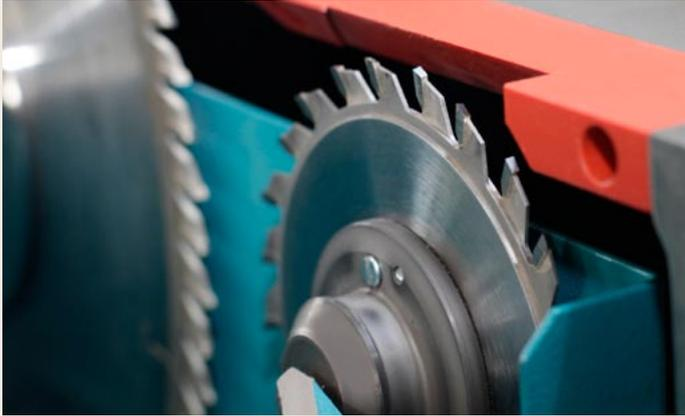
Elektrisch verstellbares 3-Achs-Vorritzaggregat T7523
