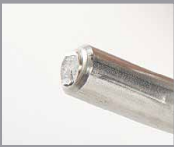
7) V-reifning CNC. Mekanisk. Glat udvendig. Grat indvendig.
