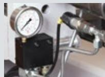
**Spanndruckregelung des Spannstocks (Option)**
