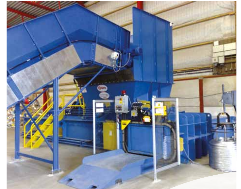
Harris 2-Wege-Ballenpresse Typ Centurion 110 kW (150 PS), 210 t Presskraft, Einfüll-Trichter 2180 x 2910 mm. Geeignet u.a. für Pappe, Reifen, harten Kunststoff, Nichtmetalle, Holz, Siedlungsabfälle.
