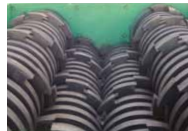
Das Innere des Q65 Shredders, 295 kW (400 PS): 4 Wellen mit Doppelhaken-Messer ausgestattet mit einem Sortierungssieb, Einfüllöffnung: 1650 x 1650 mm.
