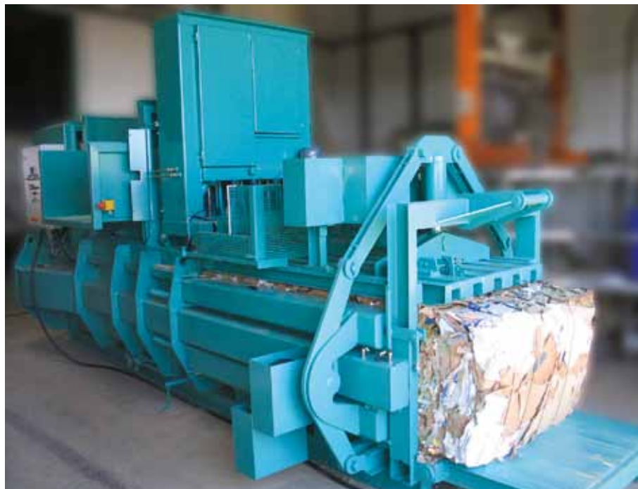
ABBA Kanal-Ballenpresse 500V5. 50 t Presskraft. Geeignet u.a. für PET, Folie, Pappe und Big Bags.
