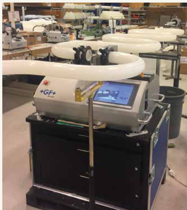
Bukkede PVDF emner bliver IR svejst. Svejse/køletid pr. samling for d63 er mellem 4 og 9 minutter afhængig af omgivelsestemperatur. Svejst på den nye IR-110 A.
