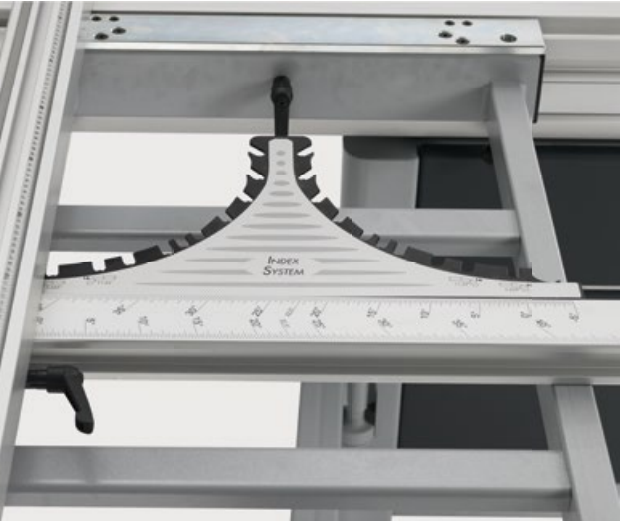
Udlæggebord med Gradskala indekssystem Du slipper for tidsspilde med manuel indtastning af vinkel værdi og hundrede procent korrekt justering og fiksering uden aflæsningsfejl – det er fordelene ved Gradraster Index System. Højpræcise rastepunkter gør det muligt at fremstille målfaste emner med flere hjørner som f.eks. 5,625° (32hjørner), 11,25° (16hjørner), 22,5° (8hjørner). Ekstra rastepunkter ved 15°, 20°, 25°, 30°, 35°, 40° og 45° kan vælges enten med skub eller stød. Alle rastepunkter er udstyret med længdekompensation. Det ekstremt præcise Gradraster Index System er indstillet fra fabrikken, og hvert eneste rastepunkt kan finjusteres enkeltvis. Den flotte maskindesign med gradskala-indeks-system øger din produktivitet til et enestående pris-ydelses-forhold.
