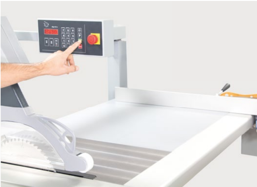
Styret parallelanslag Det vedligeholdelsesfrie linearføringssystem med kugleomløbspindelleje kører det elektriske parallelanslag hurtigt til den indtastede skærebredde med en tiendedel millimeters nøjagtighed. Parallelanslaget styres i hele længden og gør det muligt at udføre perfekte snit med max. bredde på 1250 mm.
