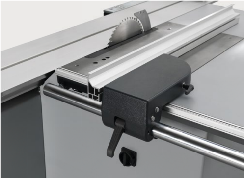
Parallelanslag Parallelsnitbredden er som standard 800 mm, efter ønske 1250 mm. Parallelanslaget indstilles let og præcist med enhånds-hurtigklemme. Den integrerede finindstilling sørger for en præcis justering. Den parallelle skæreskala er stor dimensioneret og perfekt integreret i rundsavbordet. Alu-rundsavslinalen kan skubbes bagud ved afsætning eller for bedre tilførsel af emner. Til smalle emner og lister kan alu linealen placeres liggende og således forhindre, at emnerne klemmes mellem linealen og savklingen, selv når de er smigstillet.
