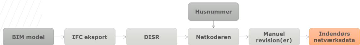
Figur 4.3 Workflow for dannelse af et netværksdatasæt af strækninger
