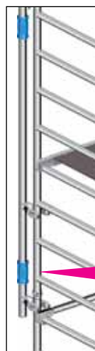
Fig. 4: Tilslutning af opskydeligt rækværk til stilladsgavlen
