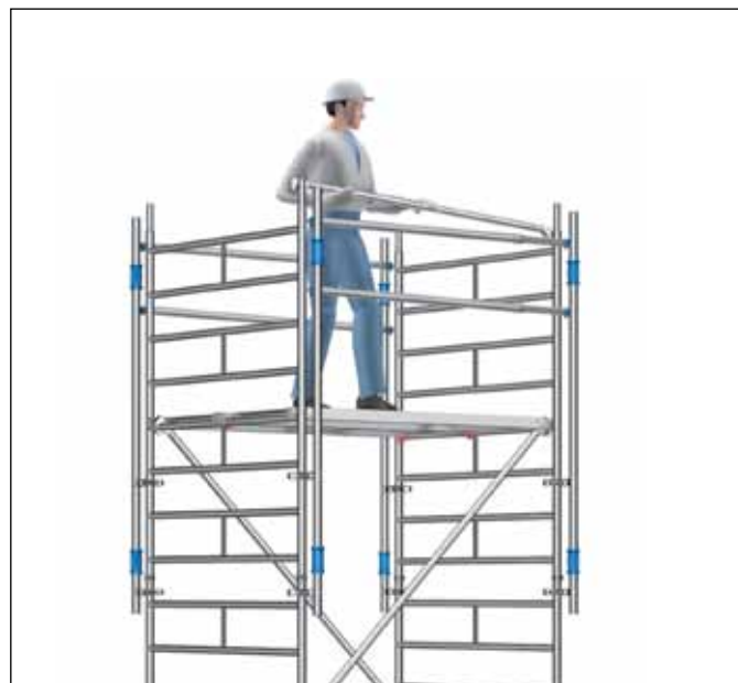
Fig. 6: Sikker montage af rækværk ved brug af det opskydelige rækværk system
