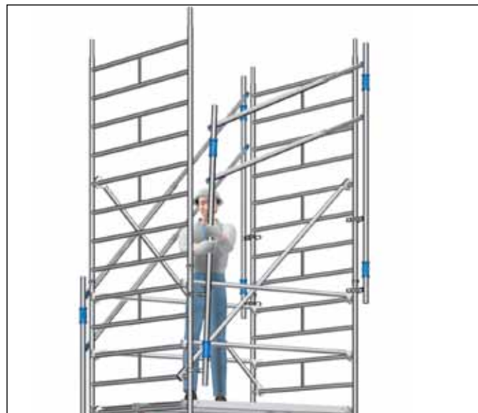
Fig. 5: Opadgående bevægelser i det opskydelige rækværk system
