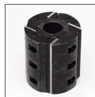
Sidokutter med monterade raka stål. Art.nr TG56.100.4K
