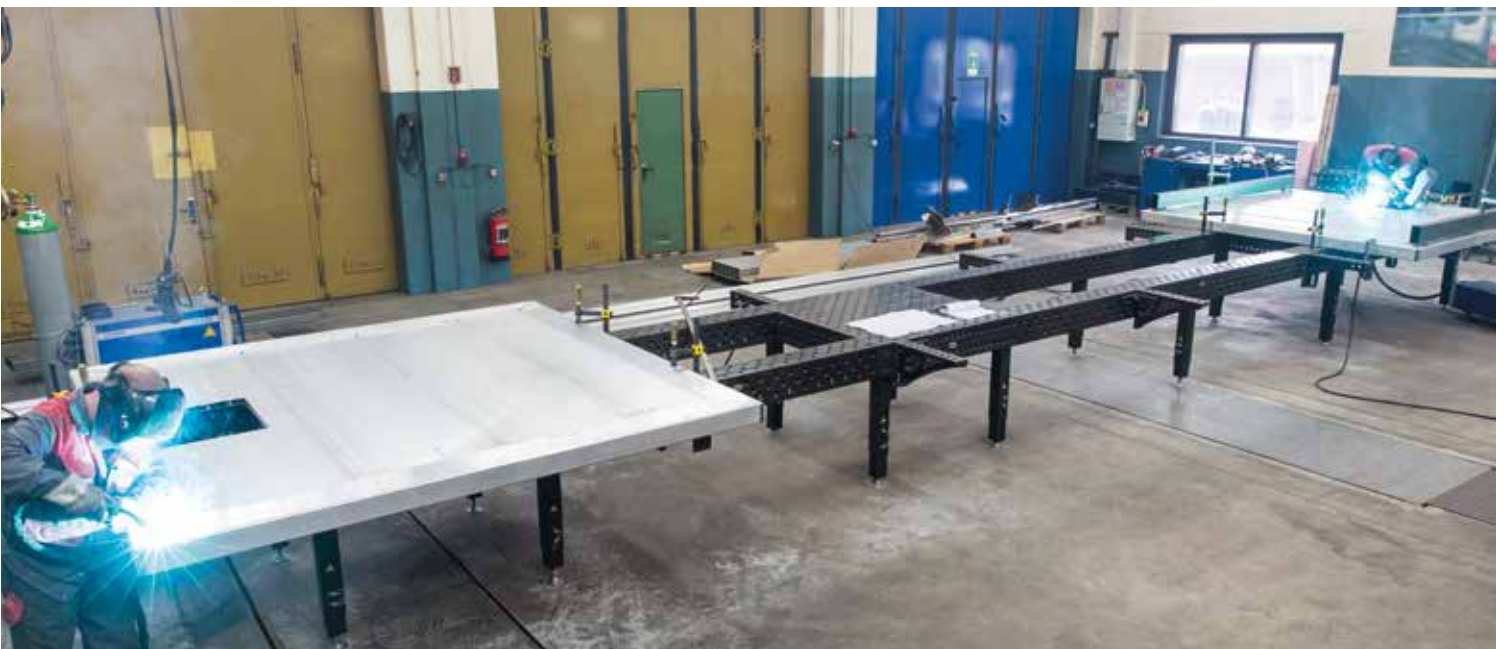
Komponentene til ei bakluke blir sveiset.
