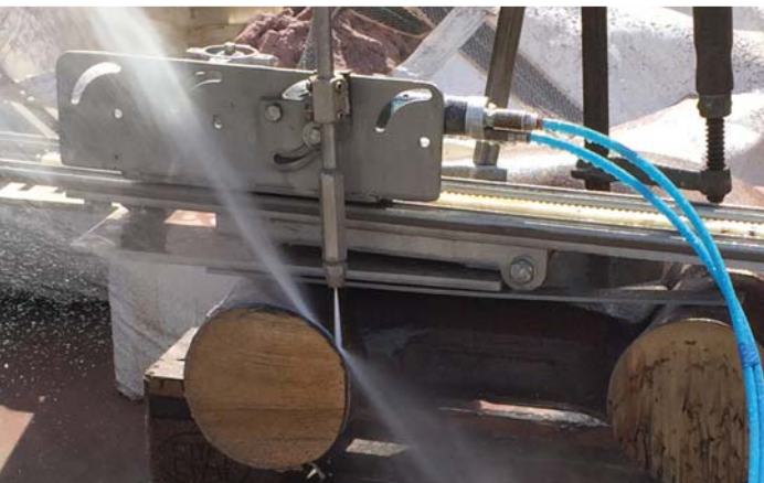
VANNSKJÆRING AV ANKERKJETTING Ø152 MM.
