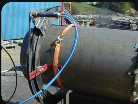
Clamp rørkutter for spesielt nøyaktige kutt. Pneumatisk drift.
