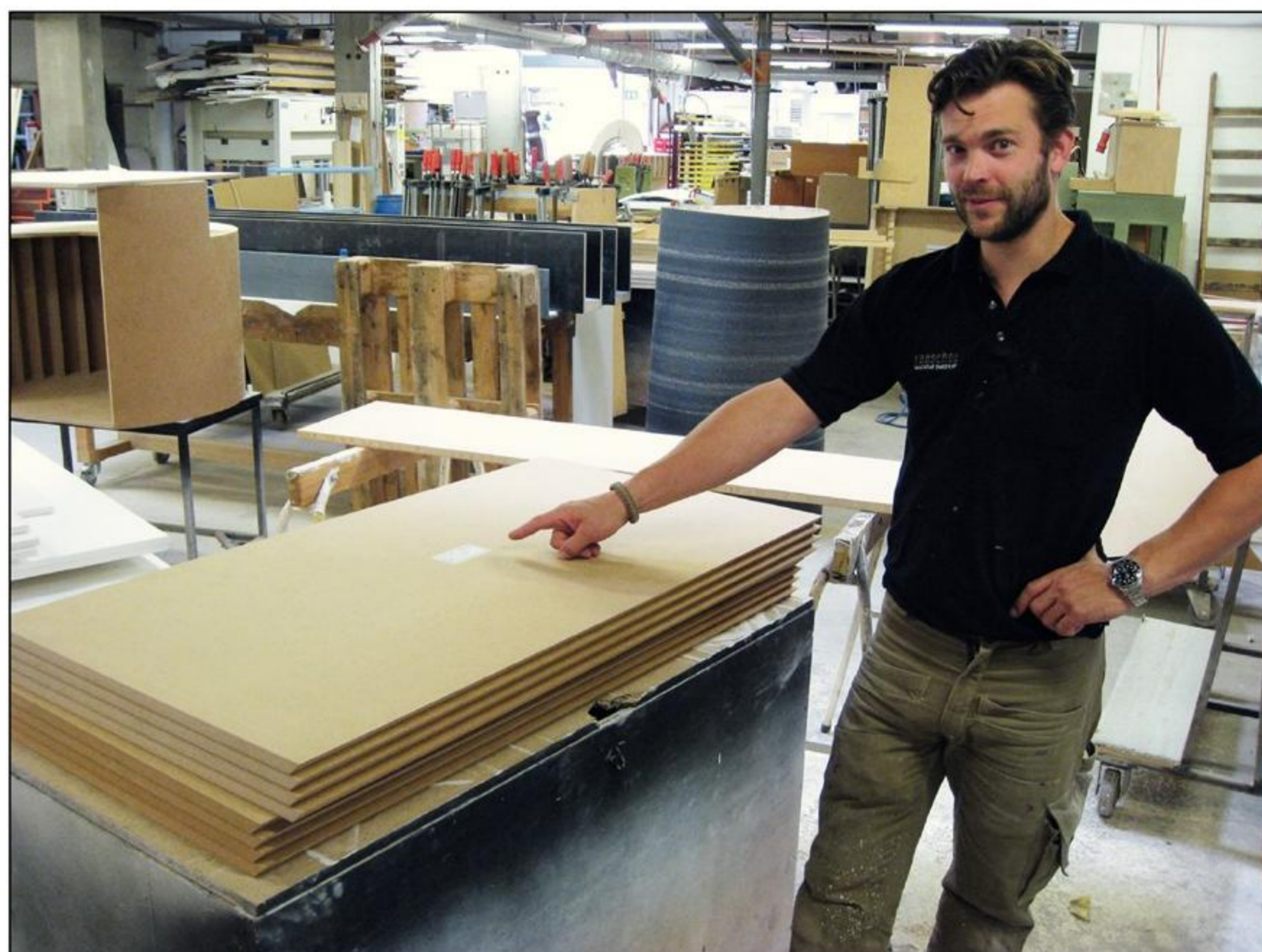
Når et emne er under produktion, bliver der efter hver bearbejdning påsat en mærkat, hvor det tydeligt fremgår, hvilken ordre emnet skal bruges til og hvilke bearbejdnings, der videre skal foregå.
