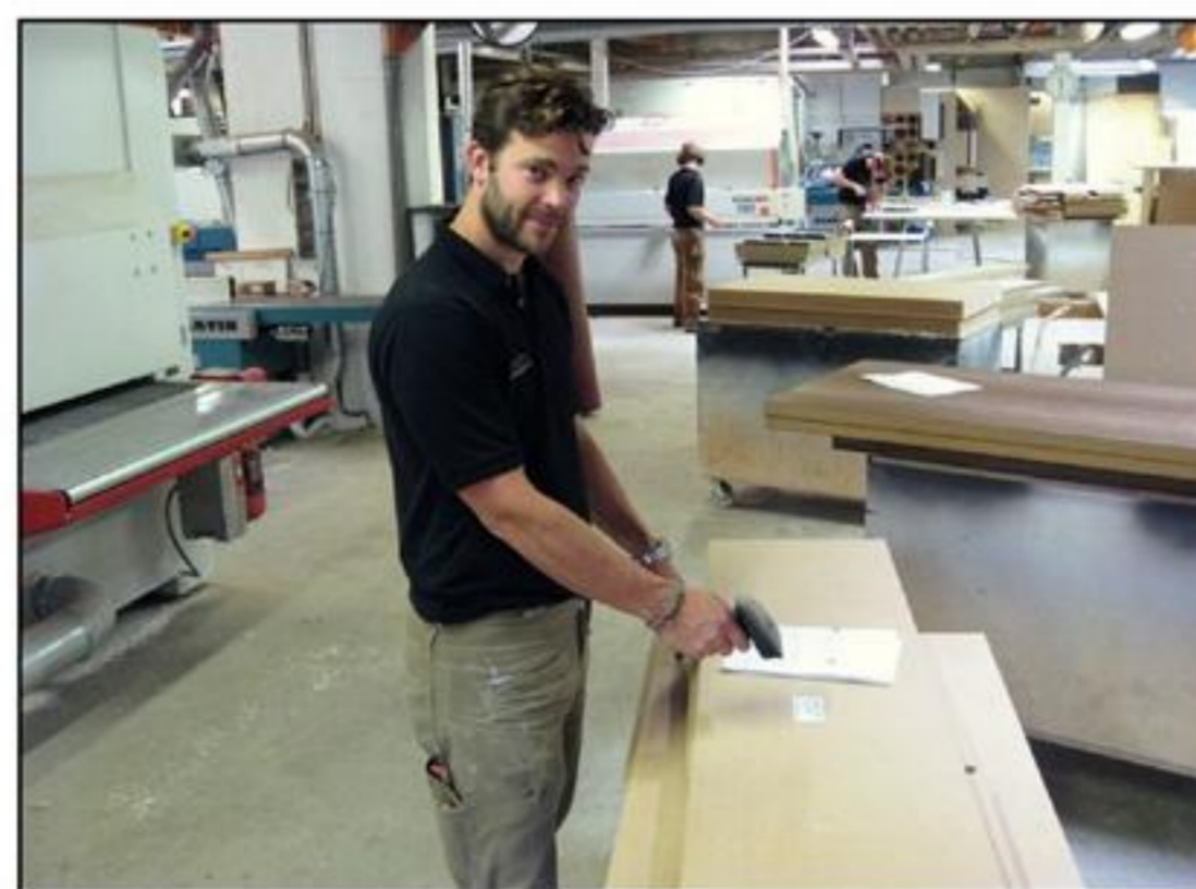
Mærkatene indeholder en Barcode, der blot skal scannes ved CNC-maskinen, som så ved nøjagtigt hvilke bearbejdnings, der skal foretages.
