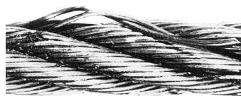
Trådbrud ved kontakt mellem kordeler eller mod kerne som følge af at kernen ikke giver kordelerne tilstrækkelig støtte. Må ikke forveksles med ydre trådbrud.
