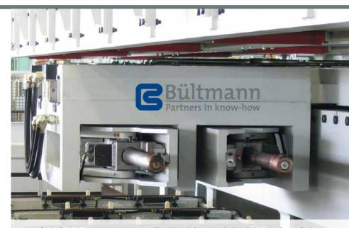
▲ 2fach-Rohrinnenspannsystem, für Aluminium und aluminiumlegierte Rohre.
