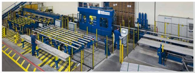
▲ Bültmann Schälanlagen für Aluminiumstangen sind speziell auf die anspruchsvollen Zerspanungskriterien von Aluminium ausgelegt.
