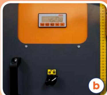
**Visualizador digital de posición (opcional).** Pantalla visor LCD para permitir un posicionamiento manual más preciso.
