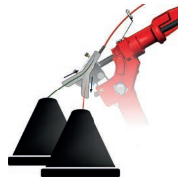
TES - Torch Exchange System (system för byte av svetspistol)
