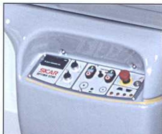
Il quadro elettrico della Optima racchiude pulsante di avviamento della lama principale con stella triangolo automatico. Il sollevamento e l'inclinazione elettrica della lama forniti di attuatore meccanico a stelo coperto offrendo grande protezione dalla polvere.
