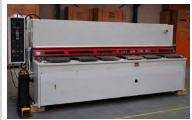
Baykal hydr. maskinsaks Type HGL 3106, årg. 2016 3060 x 6 mm, Cybtouch 6
