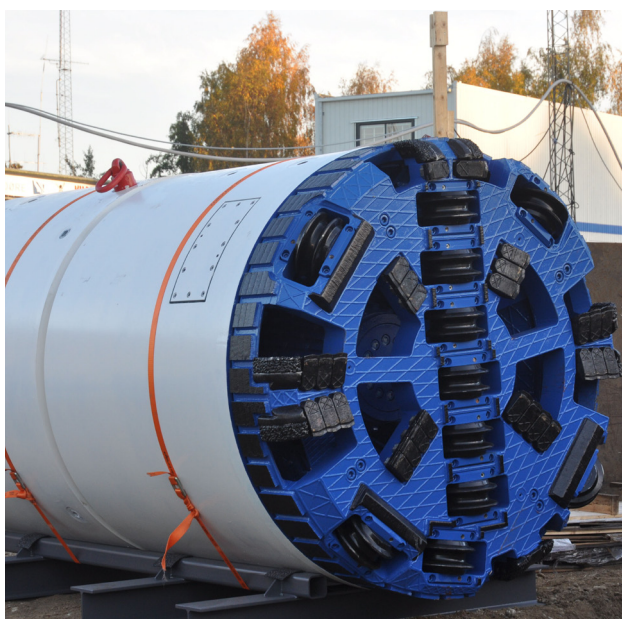
Tunneleringsmaskinens front med diameter på 2000 mm.
