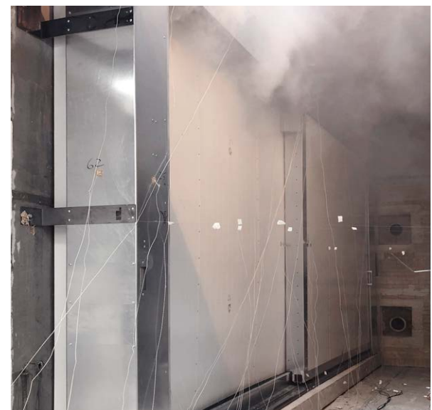
RFP SD med skydedøre under brandtesten. Der kommer røg ud af fugerne, men flammerne trænger ikke igennem. I næste øjeblik træder beskyttelsesmekanismen i kraft og undertrykker røgen.
