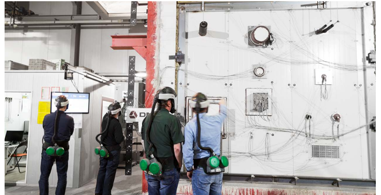
Vellykket gennemførelse af en brandtest for forskellige typer brandtætninger (kabel- og rørgennemføringssteder).
