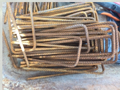
Nettet fastgøres til jorden ved hjælp af armeringsbøjler.
