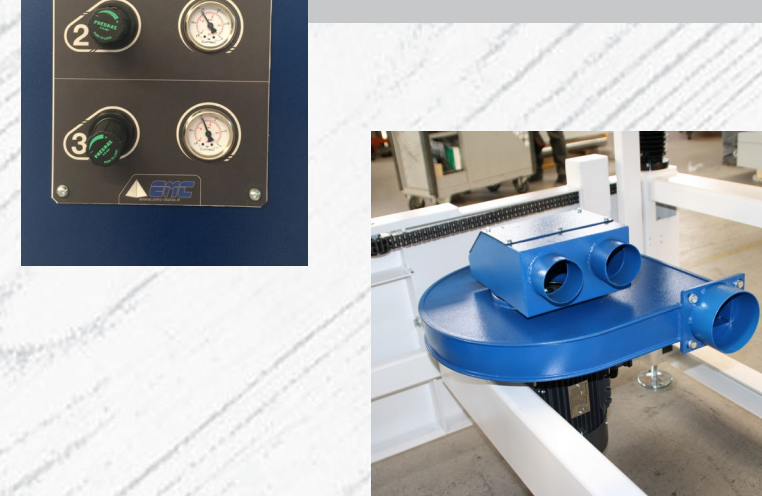
Depressore interno (taratura variabile, invertir) Internal vacuum fan (setting variable, invertir) Ventilateur dépression à l'intérieur (réglage variable, invertir)
